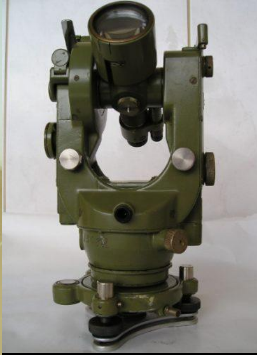
Teodolito ótico - Mecânico (T1A-Wild)
